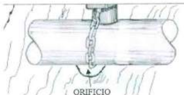
Figura 29.- El orificio deberá ser lo suficientemente grande para que se pueda pasar la cadena por él.
